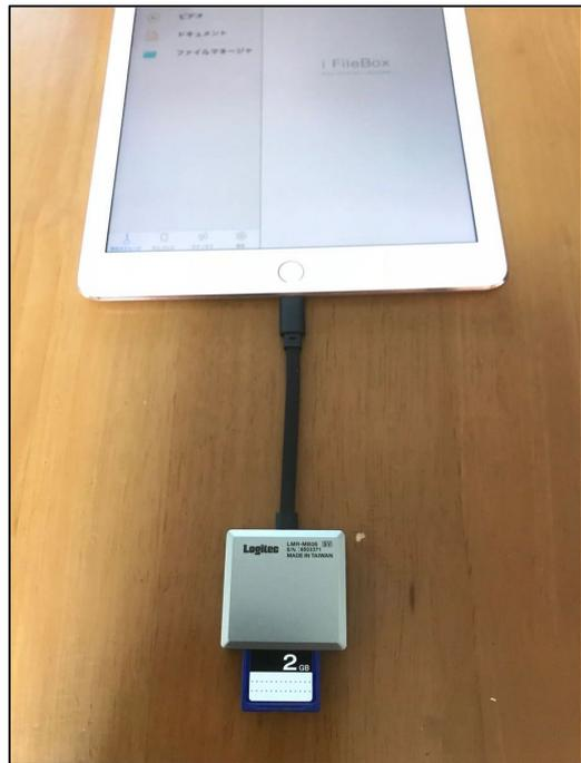
図2 SD カードから iPad ヘータを取り込むための装置
