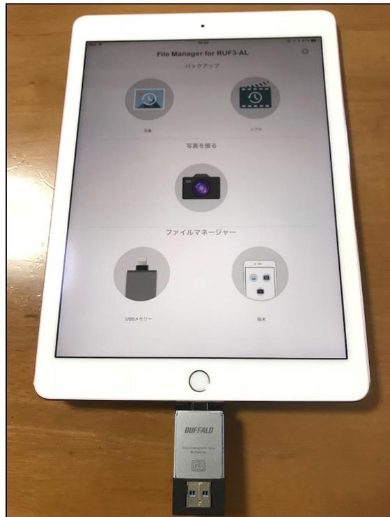
図3 USBメモリからiPadへデータを取り込むための装置
