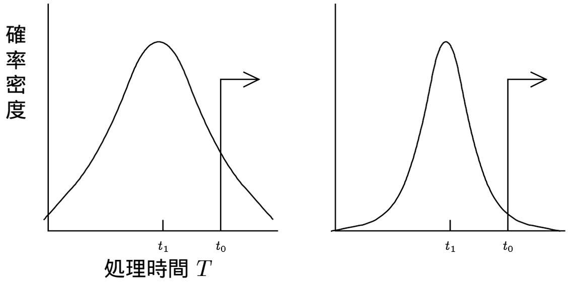
図 2.3: 処理が間に合わない確率 ( $T > t_0$  の面積)
